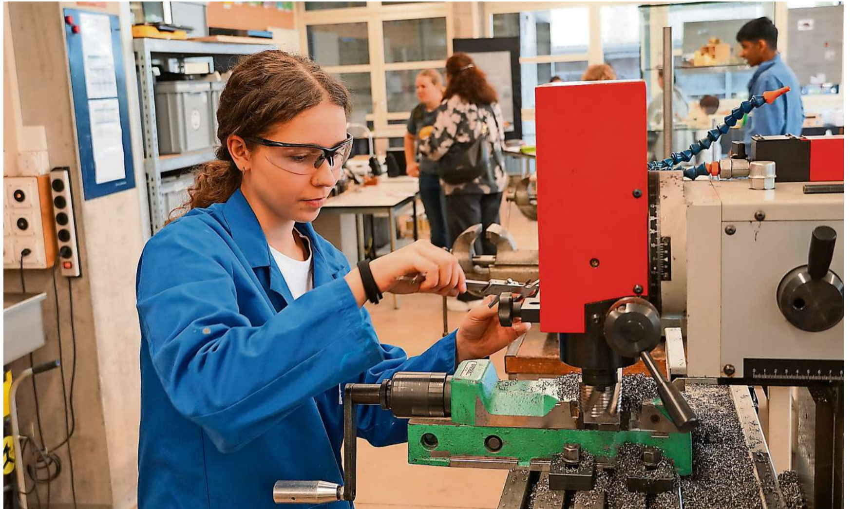
Die angehende Polymechanikerin Vivienne fertigt eine Spannpratze an der Fräsmaschine.
