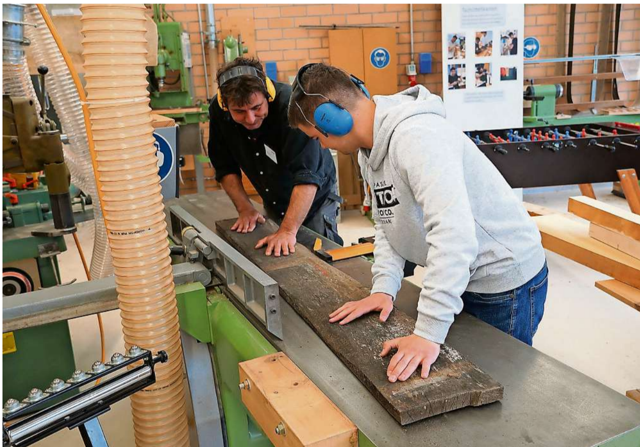
In der Holzwerkstätte ist die Hobelmaschine in Betrieb.
